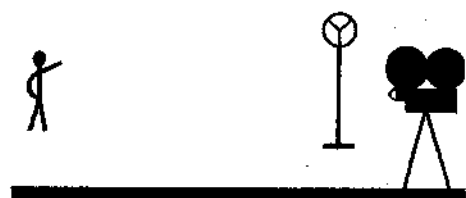
Preso a corto fuoco. - L'attore occupa circa 1/3 del campo di presa. Sullo schermo egli appare lontano e perciò il microfono dev'esser posto a una certa distanza.
