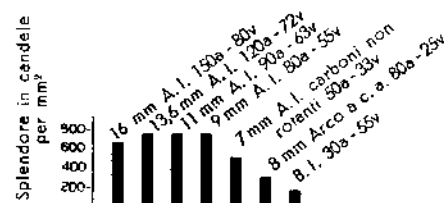
Fig. 2. - Luminosità intrinseca di lampade ad arco tipiche usate in pratica.
