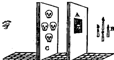
Il principio della moltiplicazione delle ombre in uno schema di Robertson. Ognuno di noi camminando per strada di sera, avrà potuto osservare come sul marciapiede, a metà via fra un fanale e l'altro della pubblica illuminazione, siano visibili a un certo momento due ombre del proprio corpo: una in avanti, prodotta dal fanale che ci si è lasciati alle spalle, e l'altra dietro, prodotta da quello al quale ci si avvicina. A nessuno di noi è però venuto in mente di trarre conseguenze dall'osservazione o addirittura di far muovere i fanali per vedere cosa ne vien fuori. Ci pensò, invece, un secolo fa, il Robertson.
