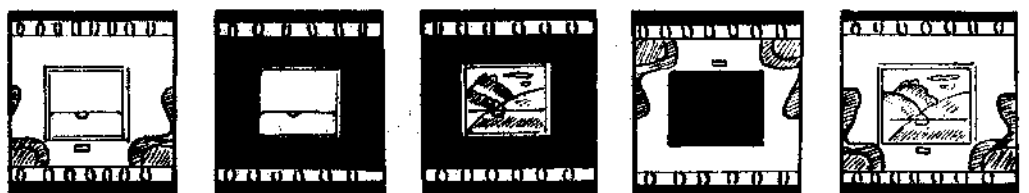
Fig. 2 - Per ottenere col sistema dei « mascherini » il paesaggio mobile mediante l'uso della 'Truca'
